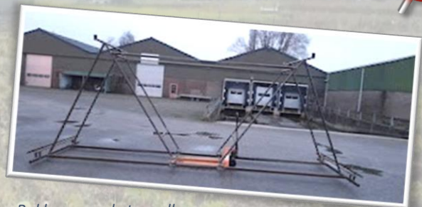
Bokken voor de tunnelbogen
